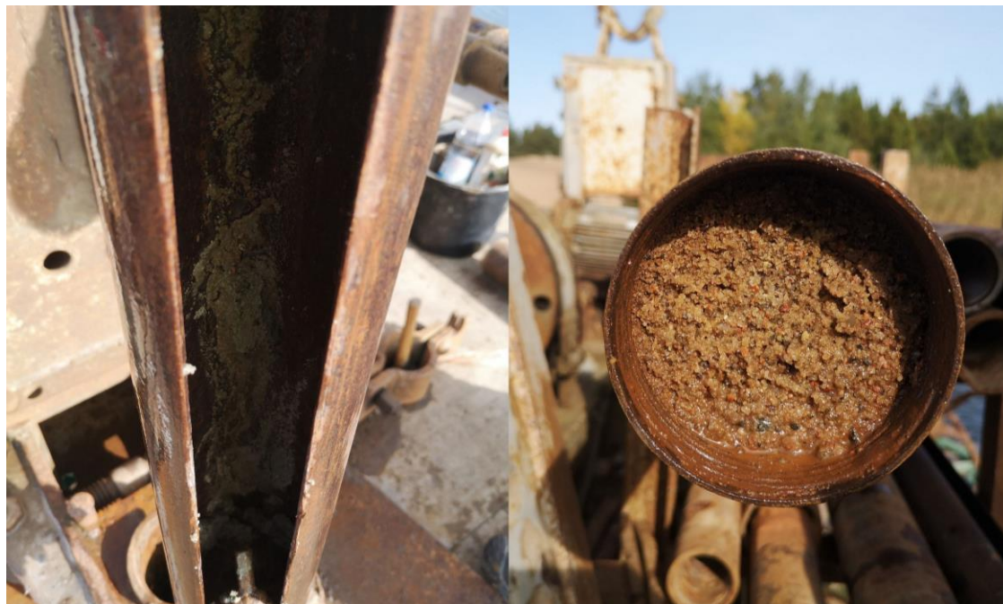
Foto 4.2. Vasakul tühjana välja tõstetud puurtoru ja paremal liivaga täitunud puurtoru (foto K. Mikkelsaar, september 2020. a)
